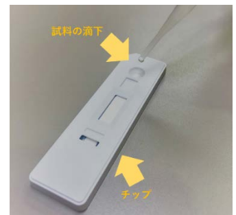
写真1: 測定時間を短縮できるチップ
