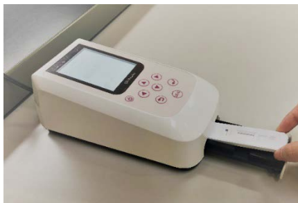
左/写真2： 蛍光イムノクロマト測定装置(QD reader)にチップをセットしている様子 右/図2： 尿内のフェリチン濃度と蛍光強度の関係性を示したグラフ 「フェリチン」の濃度に応じて蛍光強度が上昇する
